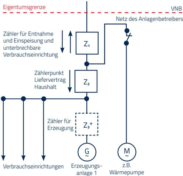
Entnahme unterbrechbaren Verbrauchseinrichtung =  $Z_1\downarrow - Z_2\downarrow$
