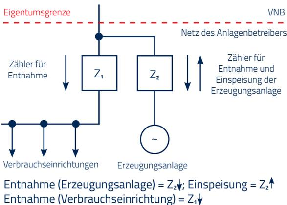
Bei einer Anlagengröße bis 30 kW(p) ist ein Ein-Energierichtungszähler zu beauftragen, ab 30 kW(p) ein Zwei-Energierichtungszähler.
