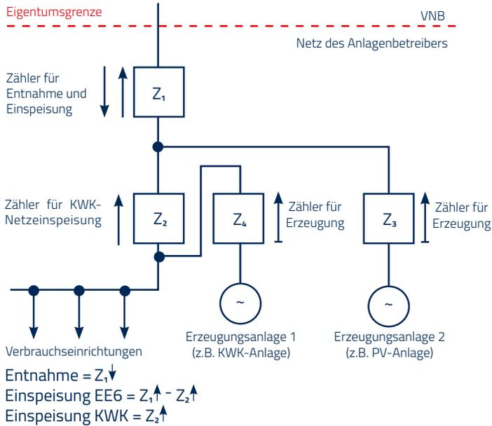
In Anlehnung an diverse Entscheidungen der Clearingstelle ist das Messkonzept 6 nur zulässig, wenn die Erzeugungsanlage 2 eine Leistung kleiner 100 kW hat. Ab einer Leistung von über 30 kW ist für die Erzeugungsanlage 2 ein Nachweis zu erbringen, dass der Eigenverbrauch der Anlage (z.B. Standby-Verluste von Wechselrichtern) kleiner 0,7 % der erzeugten Energie beträgt.
