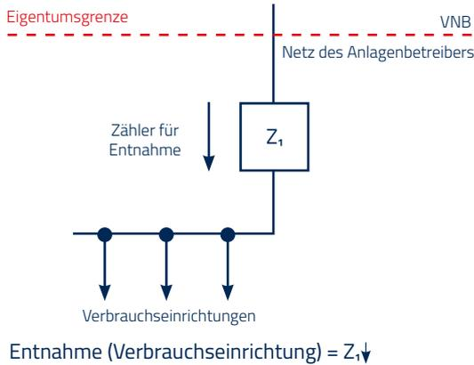
Messkonzept 0 wird für alle Standardfälle ohne Einspeisung angewendet. Es wird nur ein Einrichtungszähler für den Strombezug eingebaut.
