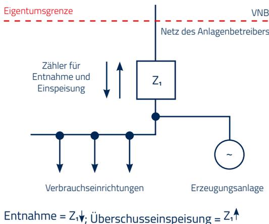
Das Messkonzept 2 wird angewendet, wenn die selbstverbrauchten Mengen für die Einspeiseabrechnung oder die Abrechnung der EEG-Umlage nicht benötigt werden. Dies ist im Allgemeinen bei PV-Anlagen ≤ 30 kW(p) (KWK ≤ 2 kW) und einer selbstverbrauchten Energiemenge unter 30.000 kWh (KWK-Anlagen unter 10.000 kWh) im Jahr der Fall.
